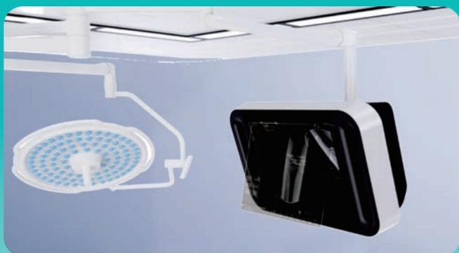
本设备是一款独创性地将光学全息投影技术、空中成像可交互技术、医学影像三维后处理技术相结合，将患者影像在空中三维呈现，并可以无接触地利用手势实现多种应用操作的辅助成像设备。
